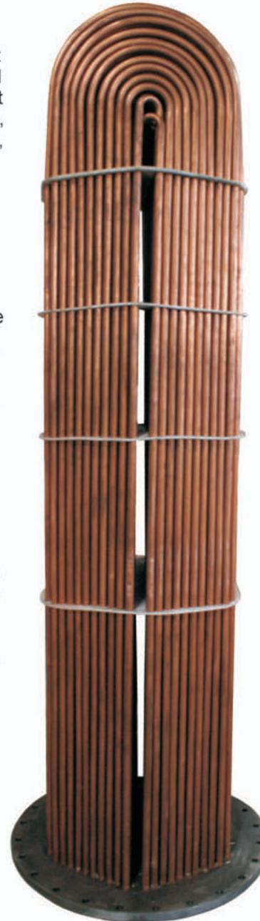
فرآیند تبادل گرما بین دو سیال با دماهای متفاوت، که توسط دیواره جامدی از هم جدا شده‌اند، در بسیاری از کاربردهای مهندسی و صنعتی روی می‌دهد. وسیله‌ای که برای این تبادل گرما به کار می‌رود، مبدل حرارتی می‌نامند. مبدل‌های حرارتی از تجهیزات بسیار مهم مورد استفاده در تأسیسات نفت، گاز، پتروشیمی، گرمایش ساختمان‌ها، تهویه مطبوع، تولید قدرت، بازیابی گرمای هدر رفته و فرآوری شیمیایی به شمار می‌روند.
